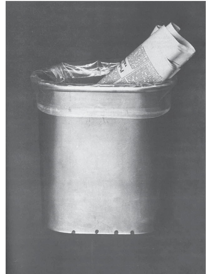
Metroasemien jäteastioiden suunnittelua ohjasi hygienianäkökulma: jäteastiat suunniteltiin pieniksi, jotta ne tyhjennettäisiin usein eivätkä jätteet alkaisi haista. Turvallisuus huomioitiin välttämällä muotoilussa teräviä kulmia.
