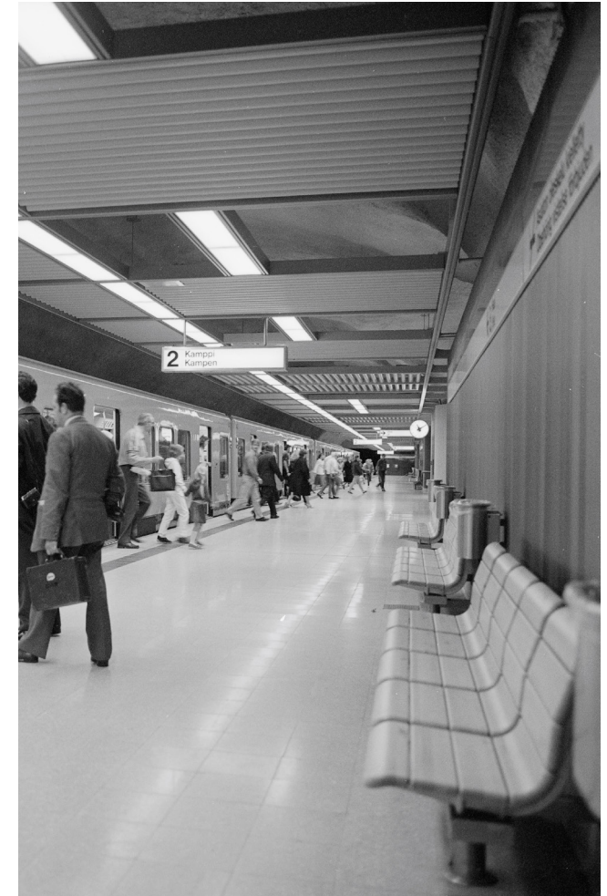
Asemalaitureiden alhaisen lämpötilan valjettua suunnittelijoille vaihtui istuimen materiaali muovista puuhun – puu olisi viileässä miellyttävämpi istua. Kuvassa Rautatietorin metroaseman laiturihalli.
