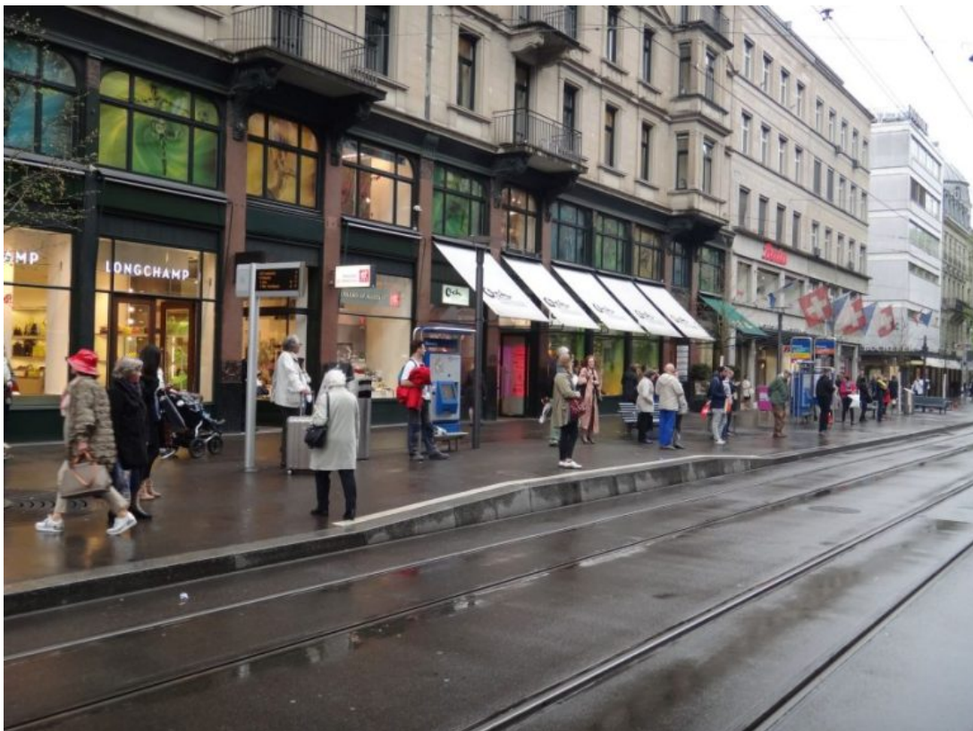
Kuva 13. Haastavassa ympäristössä vain esteettömien ovien kohdalla oleva osa raitiovaunupysäkistä on korotettu. Zürich, Rennweg (Lauri Kangas)
