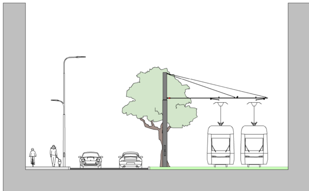
Kuva 6. Raitiotie kadun reunassa. Raitiotie oma kokonaisuus kadun reunassa. Ratasähköpylväät samalla linjalla puiden kanssa, pitkät ja kaupunkikuvassa hallitsevat orret.
