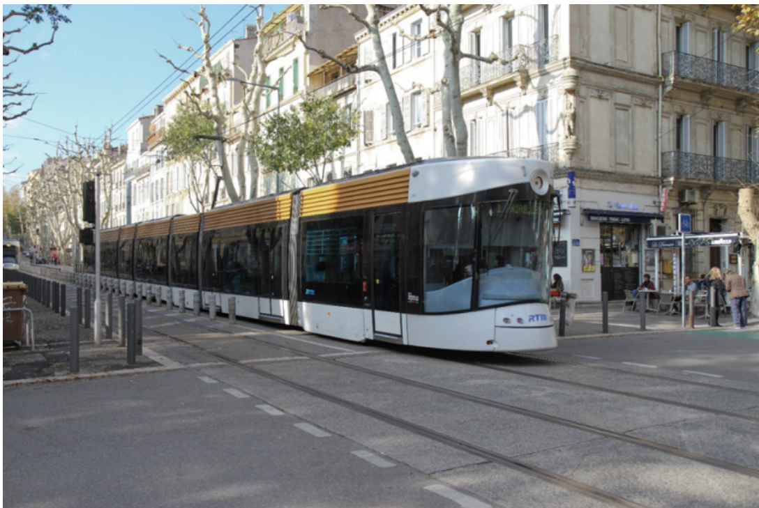
Kuva 6. Raitiotiealueen ohjaava rajaaminen pollareilla ja maaliraidalla. Marseille (Davy Beilinson).
