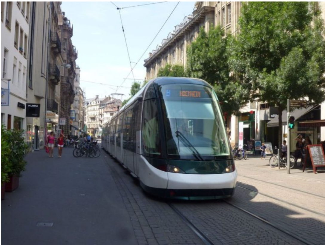
Kuva 9. Esimerkkikuva radan erottelusta kivimateriaalin, ja ladonnan muutoksilla muuhun kaupunkiympäristöön sovittaen. Strasbourg, Rue du Vieux-Marché-aux-Vins (Lauri Kangas).
