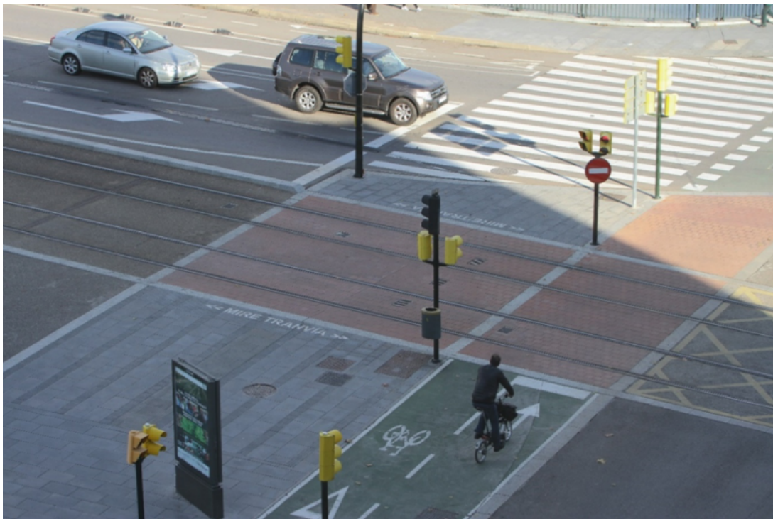
Kuva 5. Esimerkkikuva raitiotien ja ylityspaikan erottelusta materiaalein ja varoitusraidoin. Tranvía de Zaragoza (Davy Beilinson).
