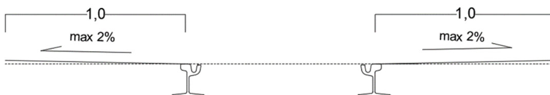
Kuva 3. Suljetun ratarakenteen päällysteen muotoilu kallistamattomassa raiteessa.
