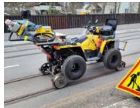
Rakentamisen aikaiset testaukset aloitettiin kiskopyörämönkijällä keväällä 2022.
