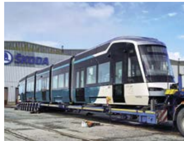
Pikaratikkaliikenteeseen valmistettavat ForCity Smart Artic X54 -vaunut ovat 34 metriä pitkiä ja matalalattaisia. Ne ovat kahteen suuntaan ajettavia, ja niissä on ovet molemmilla sivulla. HKL testaa ensimmäistä vaunua raitiotieverkolla kesästä alkaen.
